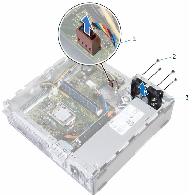
1 Cable del ventilador del chasis
